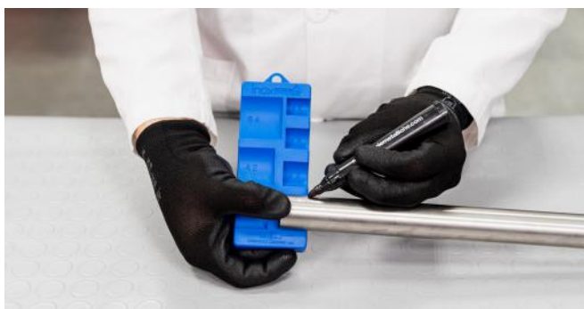
Ilustracja 28 – Oznaczanie głębokości włożenia.
