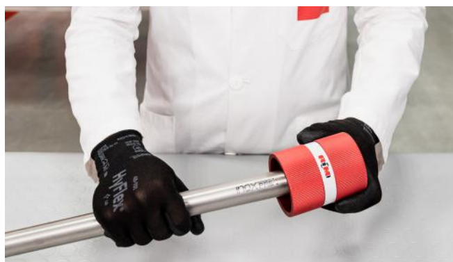
Ilustracja 26 - Stępanie krawędzi rury
