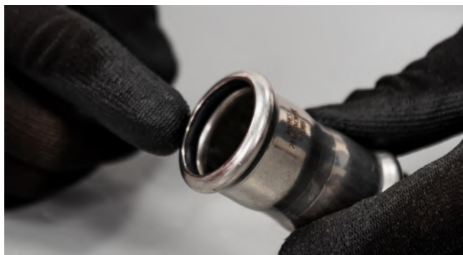
Ilustracja 30 – Sprawdzenie pierścienia uszczelniającego.
