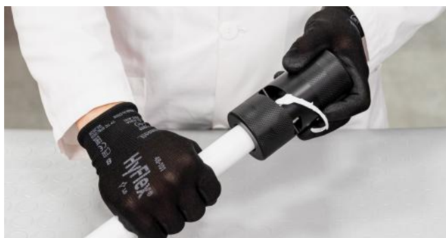
Ilustracja 29 – Obdzieranie (rura powlekana steelPRES ).
