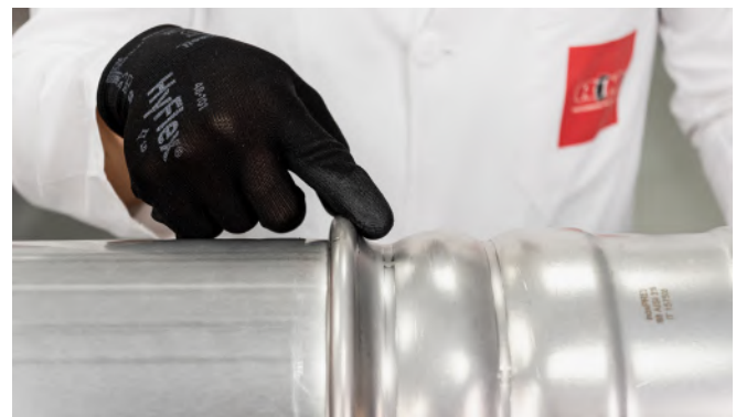
Ilustracja 36 - Kontrola wizualna tłoczenia oversize
